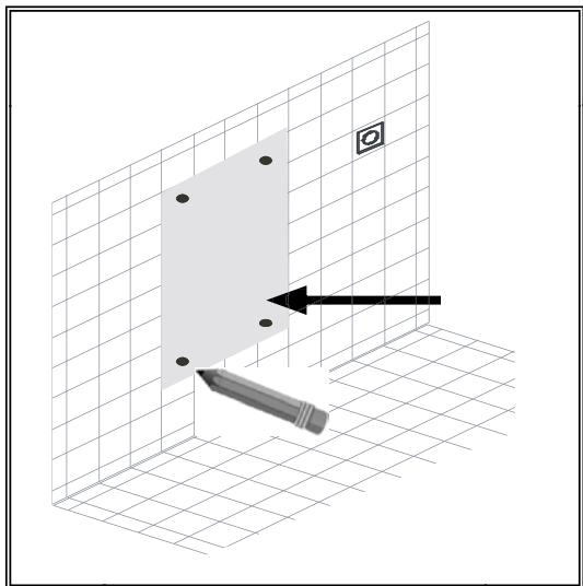
4.- PLACEZ LE PATRON DE FIXATION SUR LE MUR OÙ VOUS SOUHAITEZ INSTALLER LE PORTE SERVIETTES ET MARQUEZ LES 4 TROUS. La distance d'installation minimum du sol au thermostat est 600 mm.
