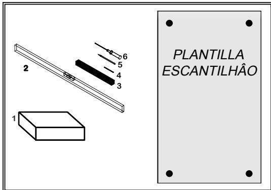
2. Sacar del embalaje la plantilla de fijación y la caja de accesorios. Recomendamos el uso de un nivel.
