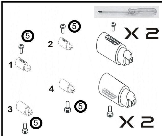
11. Atornillar LIGERAMENTE los 4 tornillos cortos N° 5 en los 4 soportes de fijación.
