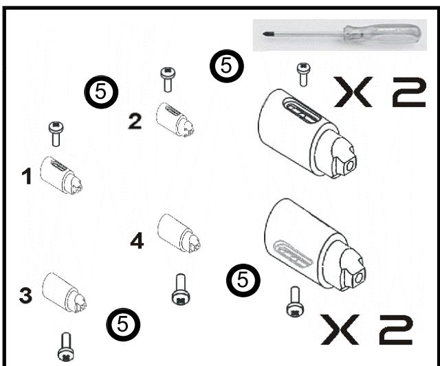
11.- VISSEZ LÉGÈREMENT LES 4 VIS COURTES N° 5 DANS LES 4 SUPPORTS DE FIXATION.
