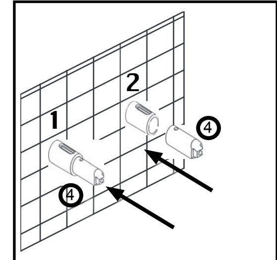
9. Introducir dos piezas N° 4 en los soportes superiores, con las ranuras hacia arriba.
