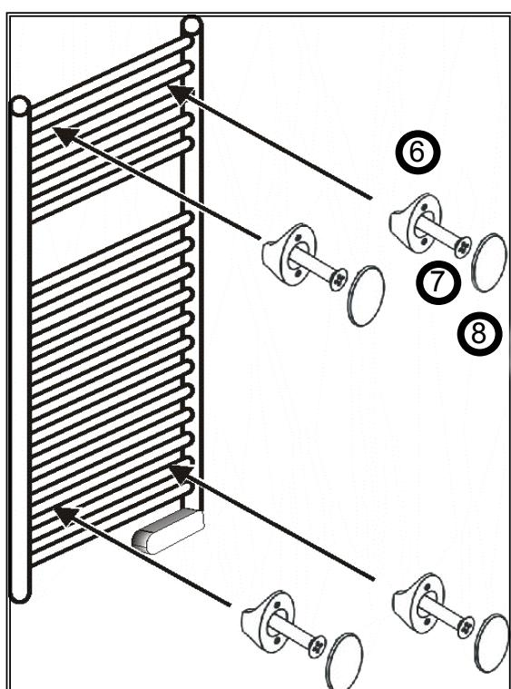
13. Coloque las 4 piezas N° 6 en los soportes de la pared y atornille ligeramente los 4 tornillos largos (pieza N° 7). Alinee el radiador secatoallas con ayuda de un nivel. Una vez alineado el radiador secatoallas apriete firmemente los 4 tornillos N° 7.
