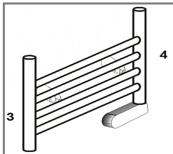
12. Coja el radiador secatoallas HAVERLAND y apoyelo en los cuatros soportes murales colocados en la pared. Coloque el radiador de tal manera que los soportes superiores queden entre la 2 y 3 barra calefactora.
